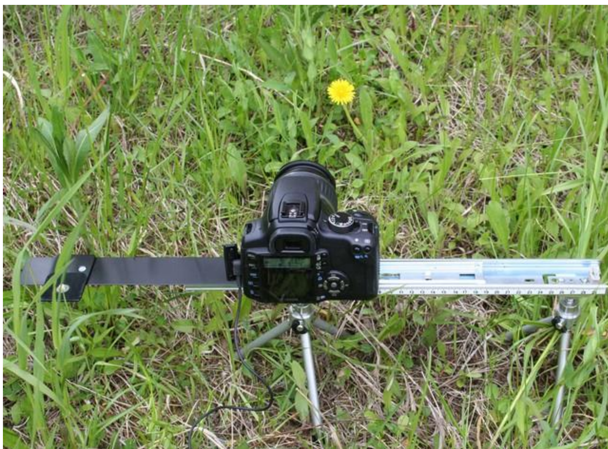
Рис. 7. Расположение объектов при многоракурсной съемке цветка
