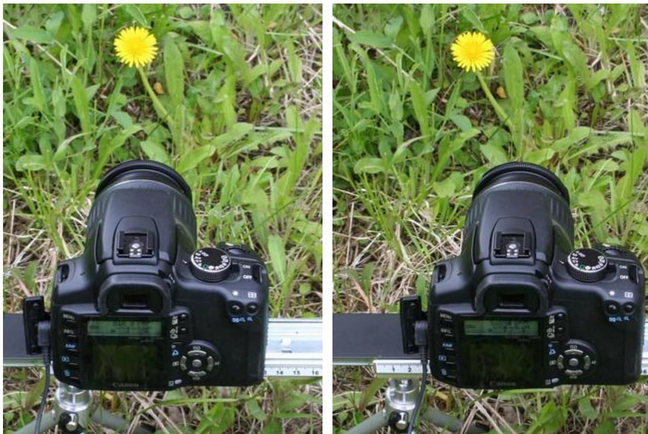
Рис. 9. Процесс многоракурсной съемки одним фотоаппаратом (показаны крайнее левая и крайняя правая позиции камеры)
