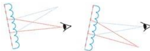
Рис. 4.1. Принцип работы вариоизображения (красным цветом обозначен первый кадр, бирюзовым — второй кадр)
